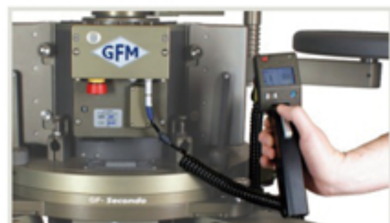
ケーブル接続 (GF-セカンド)
